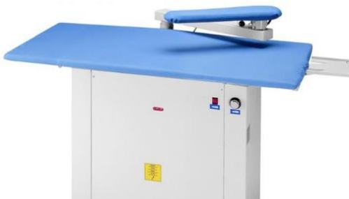
Прямоугольный гладильный с рабочей поверхностью 130 \* 70 см. Предназначен для влажно-тепловой обработки фасонных изделий: жакетов, рубашек, джинсовых и трикотажных изделий. Нагрев поверхности стола обеспечивает высушивание конденсата скопившегося при парообработке. Мощная вытяжка стола способствует более тесному прилеганию изделий к поверхности стола, что обеспечивает выравнивание при глажении.
